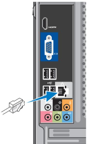
Δεν απαιτείται σύνδεση δικτύου για την ολοκλήρωση της εγκατάστασης του υπολογιστή, αλλά εάν διαθέτετε ήδη υπάρχουσα σύνδεση δικτύου ή Internet που χρησιμοποιεί καλωδιακή σύνδεση (όπως ένα οικιακό καλωδιακό μόντεμ ή υποδοχή Ethernet), μπορείτε να το συνδέσετε τώρα. Χρησιμοποιήστε μόνο ένα καλώδιο Ethernet (υποδοχή RJ45). Μην βάζετε στην πρίζα το καλώδιο τηλεφώνου (θύρα RJ11) μέσα σε μια θύρα δικτύου.
